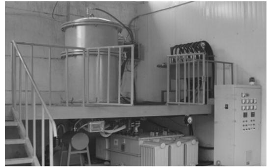
图 2 立式真空炉
