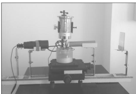
图 2 电接触试验机高速摄像光路系统
