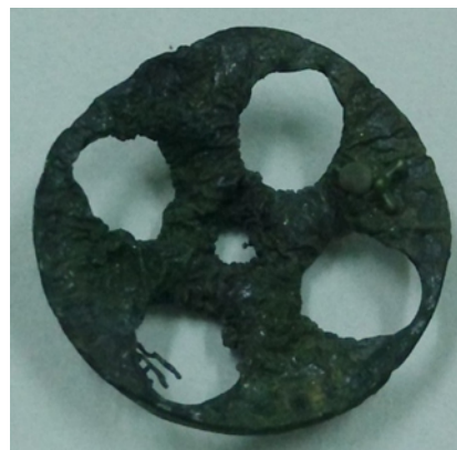
图 1 热试车后严重烧蚀变形的 GH3128 合金挡板
