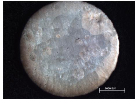
图 1 连铸 Ag-28Cu 合金的金相组织
