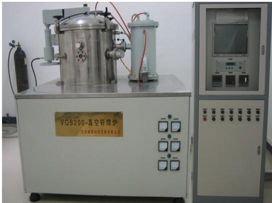
图 1 真空钎焊炉
