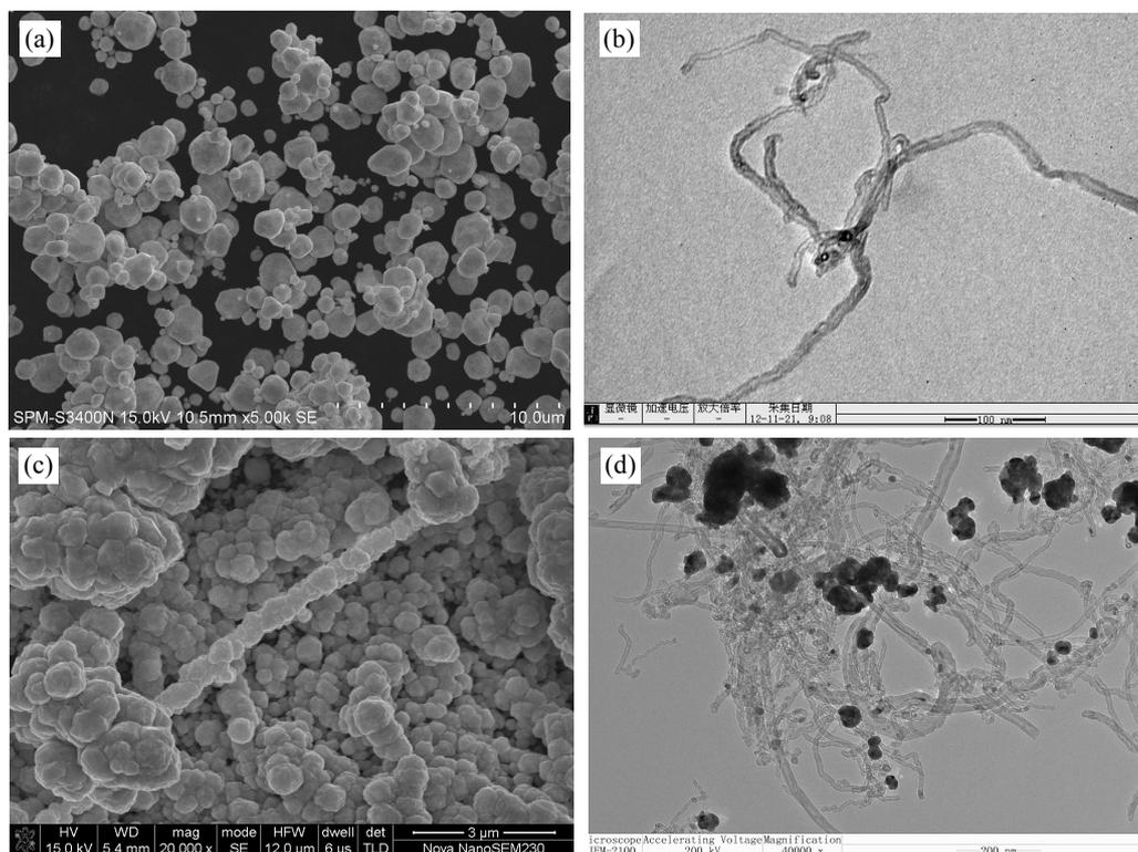
(a). SEM - electroless Ag powder (化学镀 Ag 粉末-SEM); (b) TEM - CNTs (CNTs 的 TEM); (c). SEM - electroless deposited CNT/Ag powder (化学镀 CNTs/Ag 粉末-SEM); (d). TEM - electroless deposited CNT/Ag powder (化学镀 CNTs/Ag 粉末-TEM)
