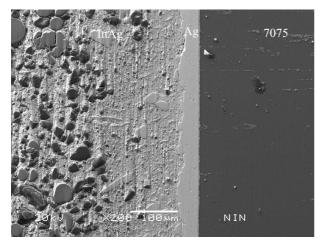
Fig.3 The SEM image of In-7Ag welded joint 图 3 In-7Ag 焊接接头的 SEM 图像
