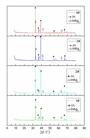
Fig.2 XRD of In-Ag Alloys 图 2 铟银合金 XRD 图谱
