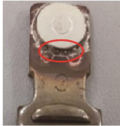
图 2 焊后组件图像(粒度 25~45  $\mu\text{m}$  钎料)
