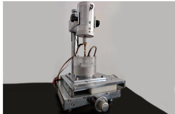
图 5 贵研金峰公司生产电接触实验机
