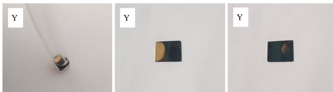
图 2 经 2 mol/L Na<sub>2</sub>S 溶液不完全浸泡 3 h 后黄色金合金样品双面照片
