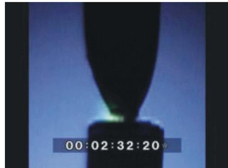
图 10 拍摄到的  $\text{AgSnO}_2$  触头上的熔桥及电弧图片
