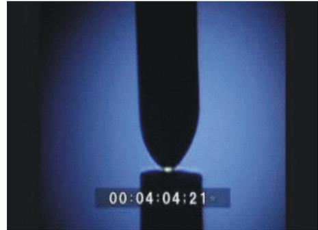
图 9 拍摄到的纯 Ag 触头上的熔桥及电弧图片
