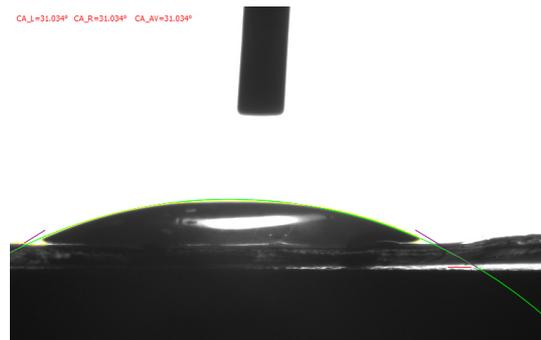
图 4 墨水在 PEN 基板上的接触角
