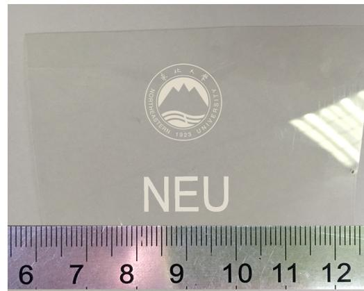
图 6 150℃ 固化 20 min 后的喷墨打印银图案
